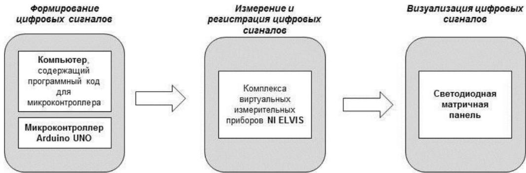
Рис. 2. Блок-схема работы учебного стенда.
